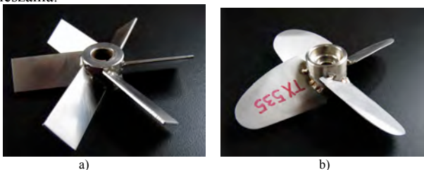
Rys. 1. Sześciolopatkowe mieszadło turbinowe (a) oraz mieszadło TX535 (b)
