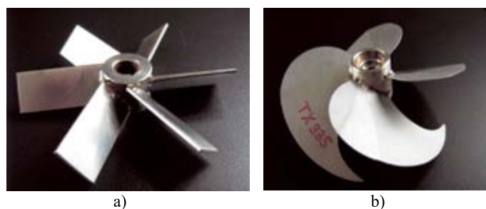
Rys. 1. Sześciolopatkowe mieszadło turbinowe o łopatkach pochylonych (a) oraz mieszadło TX335 (b)
